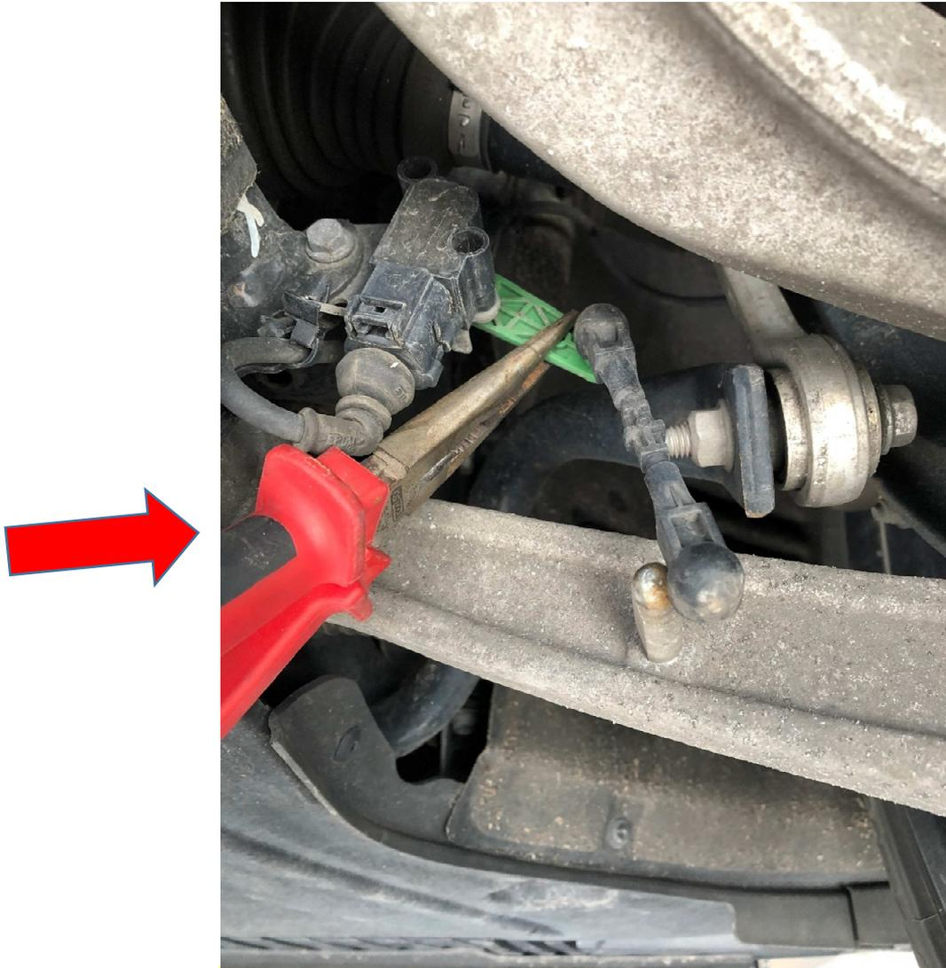
4. Montieren der neuen einstellbaren Koppelstangen. Diese werden aufgeclipst (viel leichter als die Originalen Koppelstangen). **Wichtig:** Anschließend werden die Sicherungsnasen (siehe
