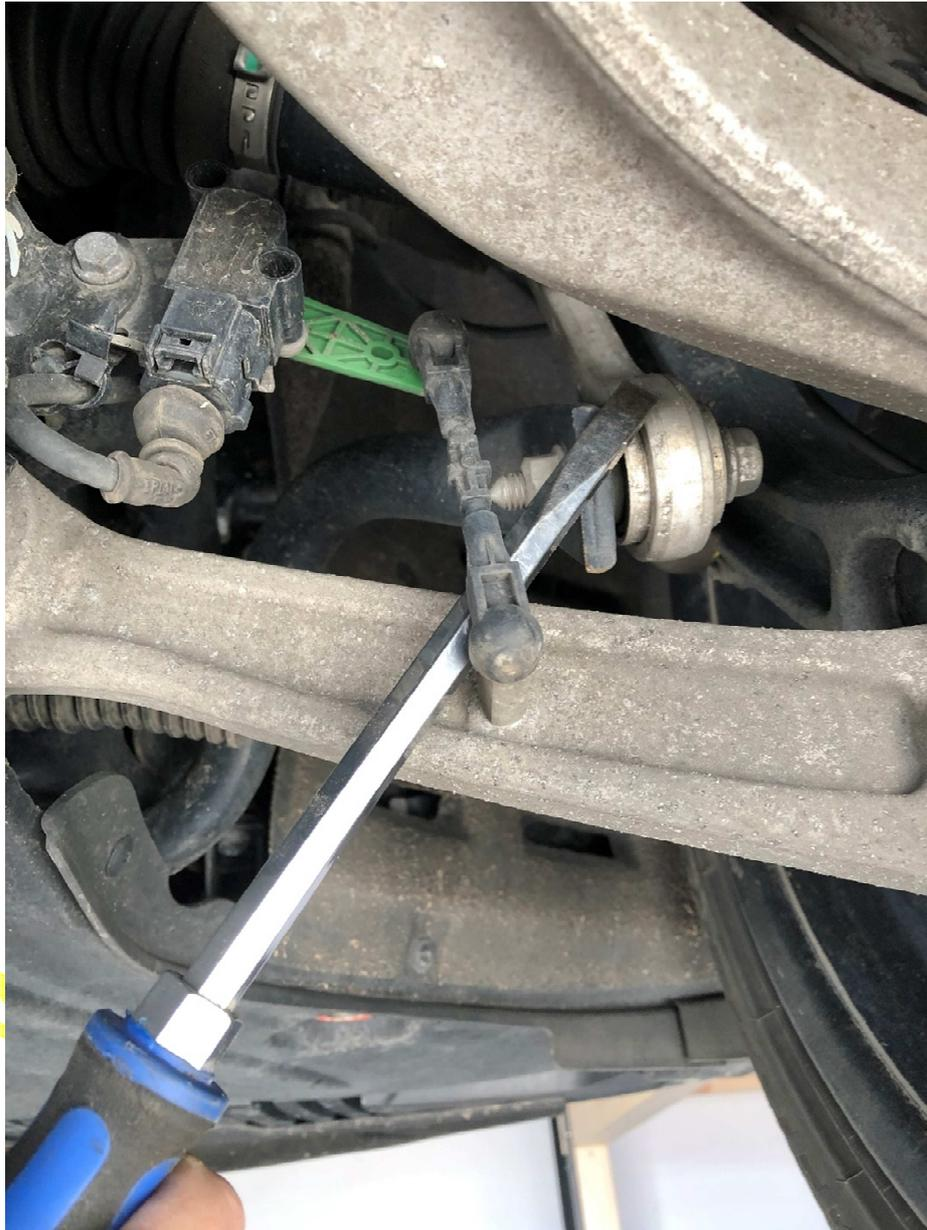
3. Hebeln Sie die Koppelstange oben am Sensor vorsichtig ab. Fixieren Sie den Sensorarm z.B. mit einer Spitzzange möglichst weit vorne am Kugelkopf. Reinigen Sie die Kugelköpfe gegebenenfalls:
