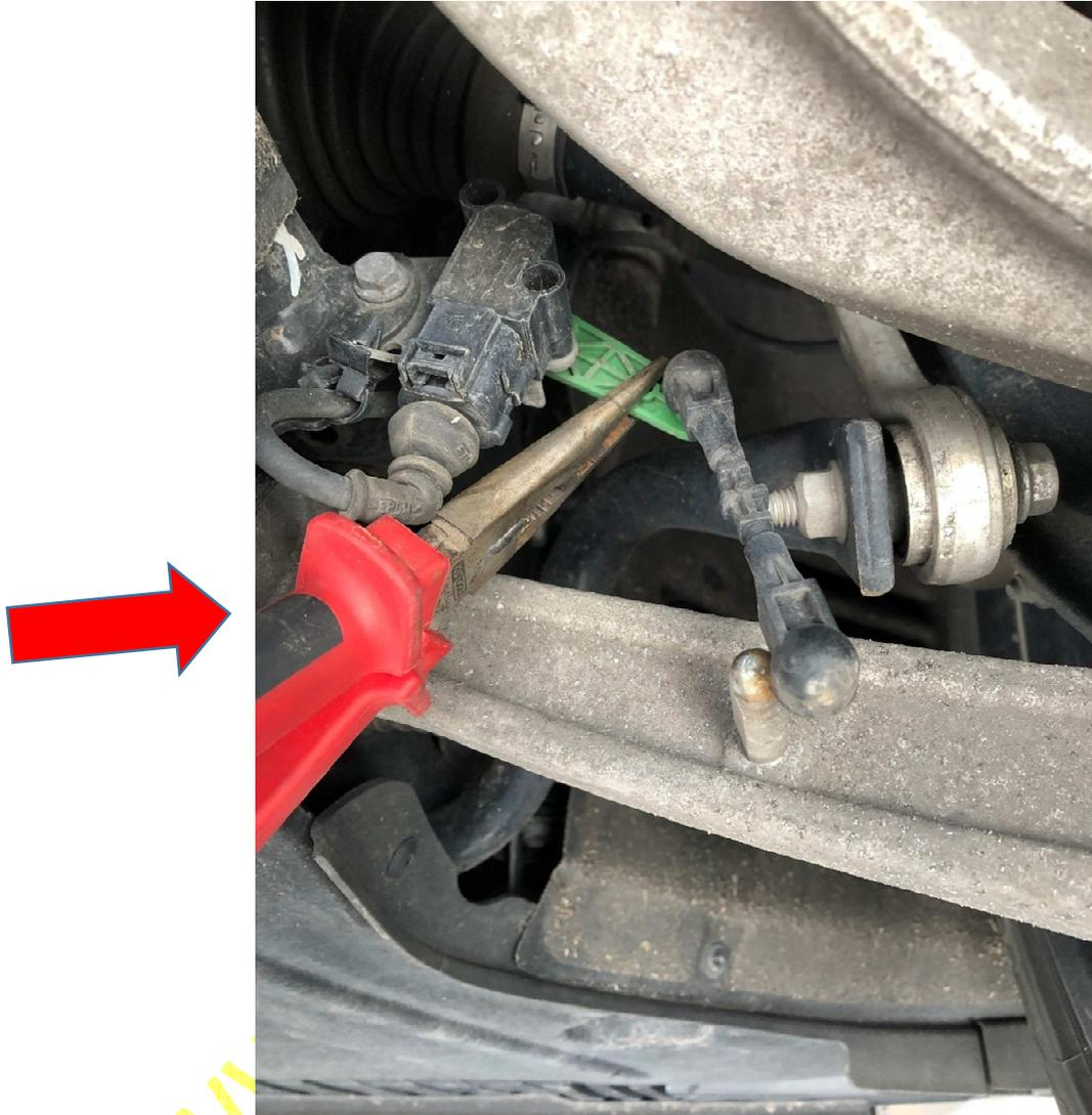
4. Montieren der neuen einstellbaren Koppelstangen. Diese werden aufgeclipst (viel leichter als die Originalen Koppelstangen). **Wichtig:** Anschließend werden die Sicherungsnasen (siehe Pfeile) oben und unten durch drücken eingerastet. Somit sind die Koppelstangen gesichert und können sich nicht lösen:
